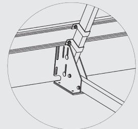
Pro Pfosten vier Hammerkopfschrauben in die T-Nut des Bordbretts einsetzen und in die Bohrungen der Haltebleche am Pfosten einführen. Anschließend Muttern anbringen und festziehen.
