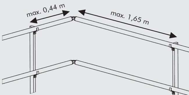
Die Abstände von den Gelenken bis zu den Pfosten sind auf einer Seite max. 0,44 m und auf der zweiten Seite max. 1,65 m.
