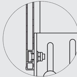
Je Pfosten zwei Hammerkopfschrauben in die untere T-Nut des Bordbretts einsetzen, in die langen Langlöcher des Pfostenfußes einfädeln, Muttern anbringen und festziehen.
