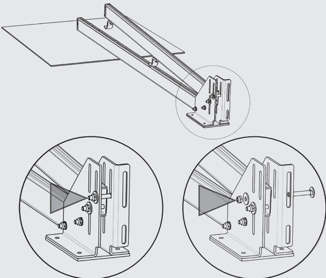
Markierte Mutter lösen und Schraube herausdrehen.
