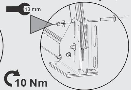
Unterlegscheibe, sowie Mutter anbringen und festziehen.
