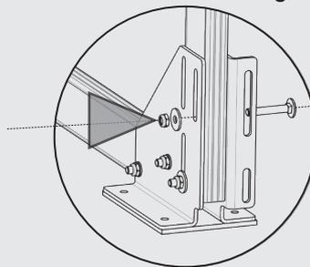
Unterlegscheibe, sowie Mutter anbringen und festziehen.
