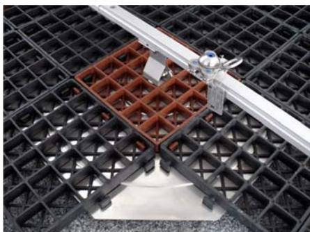
Durch Auflast gehaltene Anschlagseinrichtung gemäß DIN EN 795 Klasse E mit horizontal beweglichem Anschlagpunkt für kurzzeitige Arbeiten mit einer Persönlichen Schutzausrüstung (z. B. ZinCo Fallnet® PSA-Set, Art.-Nr. 9024) auf Flachdächern bis max. 5° Dachneigung.
