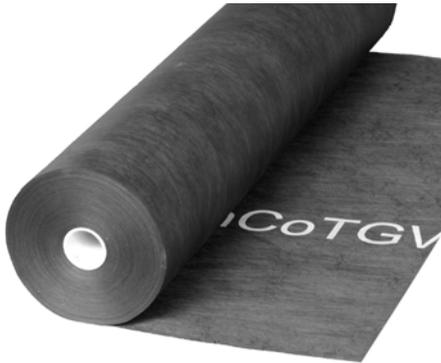
Luftdurchlässiges aber wasserabweisendes Vlies aus Polypropylen, einsetzbar als diffusionsoffene Trennlage, z. B. bei Umkehrdach-Begrünungen oder Metalldächern.
