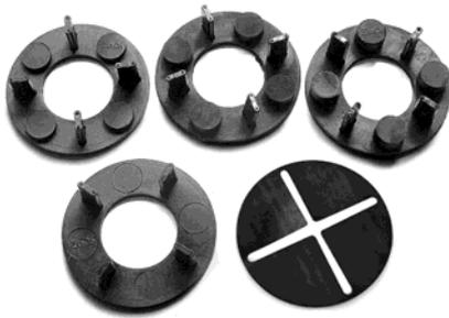
Ringförmige Plattenlager aus Synthesekautschuk mit integrierten Fugenteilern zum einfachen Verlegen von Platten auf Terrassen, Balkonen, Flachdächern, etc.
