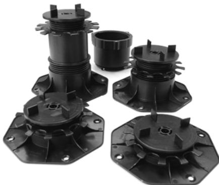
Höhenverstellbare Stelzlager mit integriertem Neigungsausgleich, zur Aufständigung von Platten- und Holzbelägen auf Flächen mit bis zu 8 % Gefälle.
