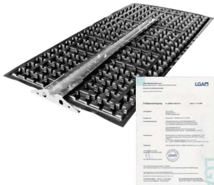
Durch Auflast gehaltene Konstruktionsbasis für durchdringungsfreie Geländerlösungen (auf Anfrage auch mit zusätzlicher Befestigungsmöglichkeit für Fallnet® SB 200-Rail) auf Flachdächern oder Dachterrassen. Die Auflast kann durch Plattenbeläge im Splittbett oder Schüttgüter (Kies, Begrünungssubstrate, etc.) erbracht werden.
