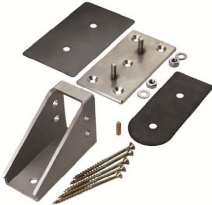
Hoch belastbarer Halter aus massivem Edelstahl zum Einbau in abgedichtete Schrägdächer nach dem Los- / Festflansch-Prinzip. Ersetzt in Verbindung mit den ZinCo-Traufprofilen Schubschwellen aus Holzwerkstoffen.
