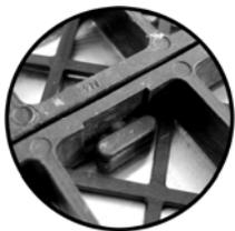
Der Schienenhalter muss flächig eben liegen, die Verbindungspunkte müssen eingerastet sein. (Eingerastete Elemente können im Bedarfsfall durch Hammerschlag wieder gelöst werden.)
