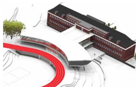
Der Entwurf des Architekturbüros zeigt sehr schön, dass die Tartanlaufbahn auf dem Dach der Klassenräume verläuft.
