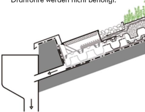
Prinzipiell ist auch eine Entwässerung mit Gullys möglich. Diese sind jedoch direkt vor der Traufaufkantung einzubauen; ein Abstand von 30 cm, wie von den Flachdachrichtlinien üblicherweise für Dachdurchdringungen etc. gefordert, ist hier nicht praxisgerecht.
