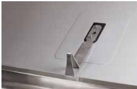
Der Schubfix LF 300 aus Edelstahl ersetzt in Verbindung mit den ZinCo Traufprofilen Schubschwellen aus Holzwerkstoffen. Er eignet sich hervorragend für flacher geneigte Dächer. Belastbarkeit pro Halter: 300 kg
