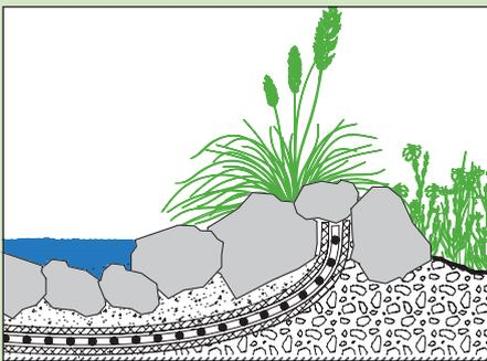
Mittels einer einfachen Einfassung und einer zusätzlichen Folie, die mit Sand abgedeckt wird, z. B. die Wurzelschutzfolie WSF 40, können Flächen geschaffen werden, die Regenwasser vorübergehend speichern. So kann für Insekten und Vögel Wasser als Badestelle oder Tränke angeboten werden. Zusätzlich wird durch solche Wasserflächen ein kühleres feuchteres Mikroklima geschaffen.
