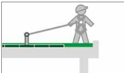
Fehlen feste Anschlagpunkte, können auch im Zuge des Begrünungsaufbaus Anschlagmöglichkeiten geschaffen werden, ob als Einzelanschlagpunkt Fallnet® SR...
