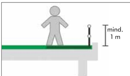
Ein Arbeitsschutzgeländer (z. B. Fallnet ASG) kann ohne Durchdringung der Dachhaut montiert werden.
