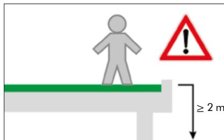
Bei Arbeiten auf Dachflächen, wozu Pflege- und Wartungsarbeiten von Gründachflächen zählen, sind ab einer Absturzhöhe von i. d. R. 2 m Einrichtungen zur Absturzsicherung erforderlich.
