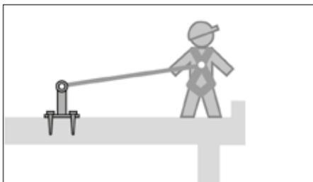
Sind weder Seitenschutz noch Fanggerüste oder Fangnetze vorhanden, können auch geprüfte Anschlagpunkte verwendet werden.
