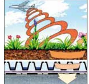
Gründächer mindern die Schall-Reflexion um bis zu 3 dB und verbessern die Schalldämmung eines Daches um bis zu 8 dB. Diese Vorteile kommen bei Bauwerken zum Tragen, die z. B. in Einflugschneisen liegen oder die sehr starke Lärmquellen enthalten (Diskotheken etc.).
