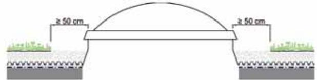
Streifen aus Kies, Zincolit® oder Betonplatten, um Dachöffnungen (z.B. Lichtkuppeln)
