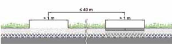
Mindestens alle 40 m ein Streifen aus Kies, Zincolit® oder Betonplatten
