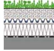
Beim „Umkehrdach“ liegt die Wärmedämmung oberhalb der Dachabdichtung, also im feuchten Bereich, was einen Dämmstoff
