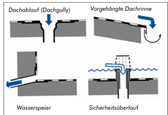
Dachfläche liegen; für Begrünungen mit Wasseranstau können jedoch spezielle Anstaeuelemente über den Dachgullys eingebaut werden.
