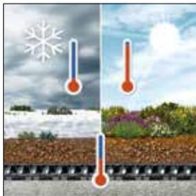
Dachbegrünungen verbessern den Dämmwert des Daches. Durch den Systemaufbau inkl. Vegetation wird insbesondere der sommerliche Wärmeschutz erhöht.
