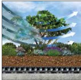
Durch die große Blattoberfläche und die Abbremsung des Luftstroms filtern Dachbegrünungen 10–20% des Staubs aus der Luft heraus. Auch Nitrate oder andere in Luft und Niederschlägen enthaltene Stoffe werden festgehalten und verwertet.
