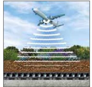
Gründächer mindern die Schall-Reflexion um bis zu 3 dB und verbessern die Schalldämmung eines Daches um bis zu 8 dB. Diese Vorteile kommen bei Bauwerken zum Tragen, die z. B. in Einflugschneisen liegen oder die sehr starke Lärmquellen beinhalten (Diskotheken etc.).
