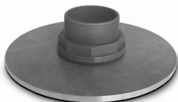
Anstaeuelement zum Aufsetzen auf Flachdachabläufe mit Anschlusskragen und Mindestgröße DN 100. Gewicht ca. 4,6 kg. Besteht aus einem Edelstahlflansch mit unterseitiger Gummidichtung, Durchmesser ca. 280 mm und einem höhenverstellbarem Überlaufstutzen (Einstellbereich von ca. 10–75 mm) aus Kunststoff, Innendurchmesser ca. 75 mm.
