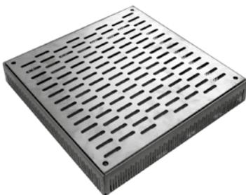
Optisch ansprechender Terrassenrost aus Edelstahl für Aufbauhöhen von ca. 65–95 mm; höhenverstellbar mit Schraubendreher von oben; Abdeckung mit Langlöchern passend zur Optik der BTR-Rinne.
