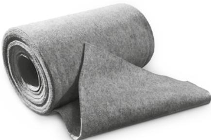
Für den Einsatz in Dachrand- und Anschlussbereichen konzipierter Schuttmatten-Streifen aus Polyesterfasern, insbesondere geeignet für die Kombination mit Fixodrain® XD 20. Als Montagehilfemit Haftkleber außen besprüht; bitumenbeständig, biologisch und chemisch neutral; Dicke: ca. 3 mm; Flächenmasse: ca. 320 g/m<sup>2</sup>.
