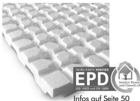
**Dränplatte zum Einsatz unter Extensivbegrünungen auf Flachdächern mit und ohne Gefälle;** aus EPS-Hartschaum; FCKW-frei; ohne HBCD; mit Wasserspeichermulden; Öffnungen zur Belüftung und Diffusion sowie unterseitigem, durchgehendem Kanalsystem; Dränageleistung geprüft nach DIN EN ISO 12958; Rohdichte: ca. 20 kg/m<sup>3</sup>; Flächenmasse: ca. 0,6 kg/m<sup>2</sup>; Höhe: ca. 50 mm.
