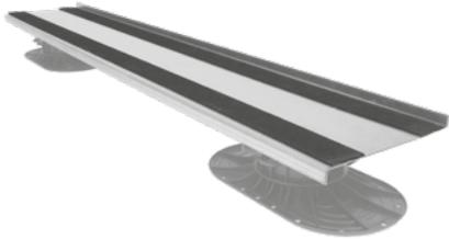
Bei der Plattenverlegung in Randbereichen, die nicht rechtwinkelig zur Verlegrichtung der Platten verlaufen, wird das Elefeet® Gehrungs- und Randaufleger genutzt. Das ca. 170 mm breite Profil wird parallel zum Randbereich auf den Elefeet® gelegt und lagert selbst kleine Belagszuschnitte auf. Die durchgehende, 15 mm hohe Aufkantung fasst den Plattenbelag ein. Die aufgebrachte Gummierung sorgt für eine rutschsichere Auflage.
