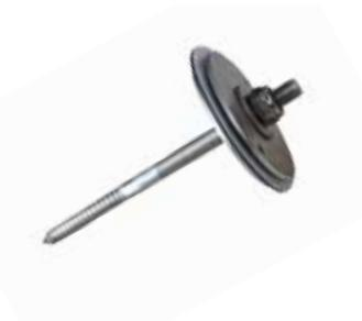
Zweiteiliger Schraubanker aus Edelstahl zur Aufnahme von Zug- und Schubkräften bis 1,5 kN bei abgedichteten Dächern, bestehend aus Stockschraube, Länge ca. 150 mm, Ø10 mm, mit angeschweißter Grundplatte (Festflansch) und loser Anpressplatte (Losflansch), Ø jeweils 70 mm, Dicke jeweils 4 mm, einschl. Zubehör zur Befestigung in Holzuntergrund. Bei Schubfix LF 150 handelt es sich um ein System „Los-Festflansch“ in Anlehnung an die Flachdachrichtlinie.
