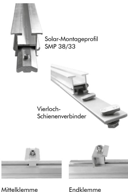
**Solar-Montageprofil SMP 38/33:** aus stranggepresstem Aluminium-Natur AlMgSi 0.5; pressblank; mit ober- und unterseitigem Profilkanal; B x H = ca. 38 x 33 mm, Gewicht ca. 0,75 kg/m; einschließlich Stoßverbinder mit Schraubmittel.
