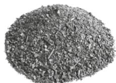
Dieses fein kornabgestufte Substrat ist speziell für Rasenflächen (bevorzugt beim Einsatz von Rollrasen) und das Verfüllen von Rasengitterwaben geeignet. Bei entsprechender Schütthöhe auch für Stauden-, Strauch- und Baumpflanzungen.
