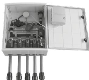
Fertig vormontierte Kopfstation für die automatisierte Bewässerung speziell von Dachbegrünungen; in verriegelbarer Kunststoffbox, Maße ca. 60 × 50 × 23 cm, inkl. Masterventil sowie Kupplung für Wasserzuleitung 32 mm, Filter, Druckminderer, Entlüftungsventil, Anschluss für Gartenschlauch sowie Kompressor, batteriebetriebenen Bewässerungscontroller, 4 Bewässerungsmagnetventile 1" mit Kupplungen für 32 mm Verlegerohr sowie Regensensor.
