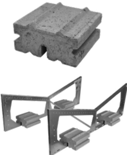
Photovoltaik-Anlagen können auf vorhandenen Dachbegrünungen nachgerüstet werden, sofern die Dachstatik dies zulässt. Die Solar-Aufständerung besteht aus je zwei ZinCo Solar-Grundrahmen SGR 15, die auf die bestehende extensive Dachbegrünung in Ost-West-Ausrichtung „Schmetterling“ platziert werden. Die ZinCo Ballast-Steine werden als Auflast gemäß Einplanung montiert.
