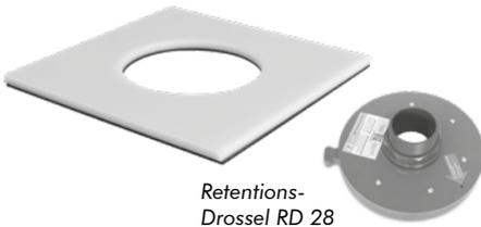
Anstau-Scheibe zur Schaffung eines Anstaus in Kombination mit der Retentions-Drossel RD 28 (siehe Seite 24); aus Polyethylen mit unterseitiger flächiger Dichtung aus Zellkautschuk, Gesamthöhe 13 mm, Abmessungen 280 × 280 mm. Es können bis zu 5 Scheiben übereinander angeordnet werden.
