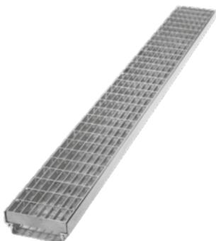
Fassadenrinnen 40 mm hoch und 100 mm breit, aus Aluminium stranggepreßt, mit begehbarem Gitterrost aus feuerverzinktem Stahl.
