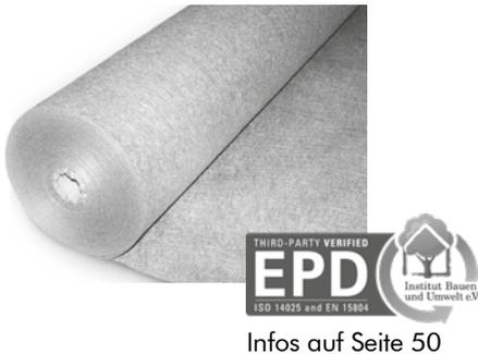
Filtervlies aus vorkomprimiertem und thermisch verfestigtem Polypropylen; verrottungsbeständig; einsetzbar als Filterschicht auf den ZinCo Dränelementen bei **normaler mechanischer Beanspruchung**; Wasserdurchlässigkeit  $H_{50}$  nach EN ISO 11058: ca. 70 l/(m<sup>2</sup> × s); Öffnungsweite ( $O_{90}$ ) nach EN ISO 12956: ca. 95 μm; Geotextilrobustheitsklasse 2; Flächenmasse: ca. 100 g/m<sup>2</sup>.
