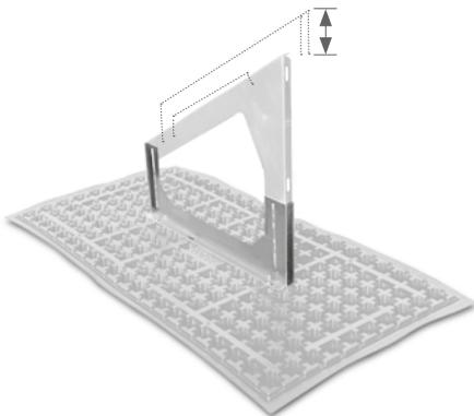
Unterteil aus Aluminium zur stufenlosen Höhenverstellung des Solar-Grundrahmens von bis zu 21 cm. Der Neigungswinkel von 5° bis 45° lässt sich um bis zu  $\pm 2^\circ$  verändern. Diese Eigenschaften garantieren eine optimale Anpassung an wechselndes Dachgefälle sowie eine bestmögliche Ausrichtung der Module. Gewicht: ca. 1 kg/Stück.
