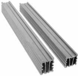
Basis des Elefeet® Schienensystems sind stranggepresste leichte Aluminium-Profile, Material EN AW 6060 T66, mit entsprechenden Verbindern aus verzinktem Stahl, die in Kombination mit Elefeet® Stelzlager das zügige Herstellen einer stabilen Terrassen-Unterkonstruktion ermöglichen. Speziell geeignet auch bei nicht allseitig eingefassten Gehbelägen aus Beton- oder Natursteinplatten sowie Holz- oder WPC-Dielen.
