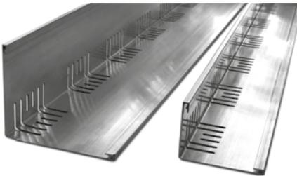
Beidseitig verwendbare Winkelprofile aus stranggepresstem Aluminium natur mit Entwässerungsschlitzen über Eck; zur Trennung unterschiedlicher Aufbauten, wie z. B. Kiesrandstreifen zu Begrünungen, Randstreifen aus Zincolit® plus oder ähnlichem.
