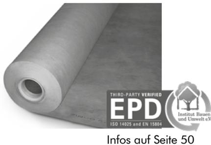
Thermisch verfestigtes Filtervlies aus Polypropylen; **mechanisch hoch belastbar**, daher einsetzbar auf Dränschüttungen; Wasserdurchlässigkeit  $H_{50}$  nach EN ISO 11058: ca. 40 l/(m<sup>2</sup> × s); Öffnungsweite ( $O_{90}$ ) nach EN ISO 12956: ca. 85 μm, Geotextilrobustheitsklasse 3; Flächenmasse: ≥ 175 g/m<sup>2</sup>.
