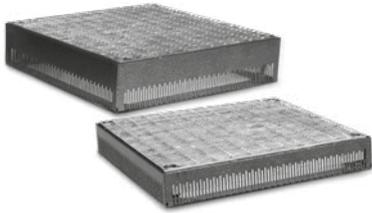
Höhenverstellbare Entwässerungsroste aus verzinktem Stahl mit beschichtetem Kiesfangrahmen. Die grobe Höhenanpassung erfolgt durch Wahl des entsprechenden Kiesfangrahmens; bei Bedarf in Kombination mit dem ca. 60 mm hohen Aufstockelement; die Feinjustierung mit einem Schraubendreher von oben, ohne Ausbau des Rostes. Auf diese Weise ist der höhenverstellbare Terrassenrost 40 × 40 für Aufbauhöhen von ca. 65 mm bis 185 mm geeignet.
