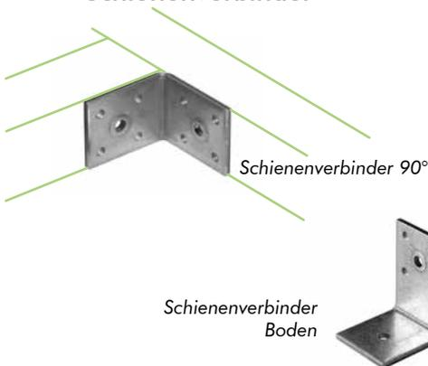
Um das Schienensystem stabil und sicher aufbauen zu können, gibt es je nach Bedarf und Begebenheit verschiedene Verbinder mit speziellen Noppen zur Verdrehesicherung. Diese können passend in die Rillen der Schienen eingesetzt und die jeweiligen Verbinderelemente somit sicher und passgenau verschraubt werden. Alle Verbinder sind aus verzinktem Stahl, sind auf Bestellung aber auch aus Edelstahl erhältlich.
