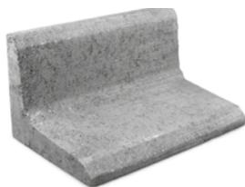
**Öko-Betonwinkelstein** zur Einfassung von Pflanzbereichen, zur Abgrenzung von Geh- und Terrassenbelägen oder zur Ausbildung von Trögen, etc. Länge ca. 500 mm; Schenkellängen: ca. 250 mm / 300 mm; beidseitig verwendbar; Gewicht: **nur ca. 28,5 kg**.
