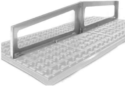
Schraubenset zum Herstellen einer Ost-West ausgerichteten Solaraufständerung, um die SB 200-4 und zwei SGR zu montieren. Pro Aufständerung werden zwei SGR (siehe Seite 46), Art.-Nr. 9700xx und eine SB 200-4 Art.-Nr. 3465 benötigt. Die Montage kann mit einem Hochpunkt zwischen den beiden Modulreihen erfolgen („Sattel“) oder mit einem Tiefpunkt („Schmetterling“). Material: Edelstahl.
