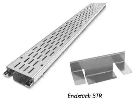
Höhenverstellbare Rinne aus hochwertigem Edelstahl; Abdeckung mit Langlochschlitzung, Rinnenkörper unten/seitlich geschlitzt, einschließlich Stoßverbinder. Rinnenbreite: ca. 107 mm; Breite der Abdeckung: 100 mm; Höhenverstellbereich: ca. 40 bis 55 mm.
