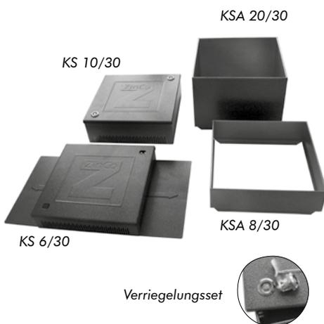
Kontrollschächte aus kunststoffbeschichtetem Aluminium, Deckel und Aufstockelemente aus verzinktem und kunststoffbeschichtetem Stahlblech; zum Aufsetzen auf die Dränelemente, in Kombination mit Retentionsdrosseln oder zum Einbau in Schüttstoffe; passend für alle Gullygrößen. Bei Bedarf lassen sich die Kontrollschächte auch verriegeln. Durch Kombination mit den Aufstockelementen KSA sind die Kontrollschächte auch bei höheren Schichtaufbauten einsetzbar.
