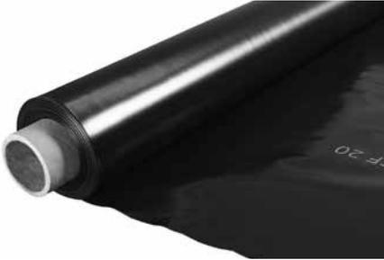
Chemisch neutrale Hochdruck-Polyethylenfolie zum Einsatz als Trenn- und Gleitfolie unter Dachbegrünungen oder Geh- und Fahrbelägen; bitumen- und polystyrolverträglich; beständig gegenüber den meisten Chemikalien; UV-stabilisiert; glatte Oberfläche; dampfsperrend ( $s_d \geq 100 \text{ m}$ ); Farbe: schwarz; Dicke: ca. 0,20 mm; Flächenmasse: ca. 190 g/m<sup>2</sup>; WDD-äquivalente Luftschichtdicke:  $s_d \geq 40 \text{ m}$ ; Gleitreibungskoeffizient: 0,30.
