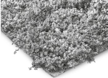
Über eine Vegetationsperiode im Freien vorkultivierte Pflanzenmatten für die schnelle Flächendeckung; speziell geeignet bei Schräg- und Tonnendächern oder windexponierten Dachflächen; mit fest verwurzelten Pflanzen (4–8 bewährte Sedum-Sorten sowie für extensive Dachbegrünung geeignete Kräuter und Gräser) auf einer verrottungsfähigen Trägereinlage; geringfügiger Schrumpf und Fremdbewuchs ist möglich. Liefergewicht: ca. 16–20 kg/m<sup>2</sup>; Dicke: ca. 30–40 mm.
