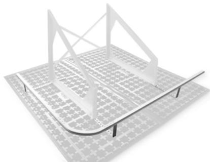
In Kombination mit der ZinCo Solarbasis® SB 200 und Solargrundrahmen SGR zu montierendes Schienensystem mit horizontal beweglichem Anschlagpunkt, dem sogenannten Läufer; geprüft als durch Auflast gehaltene Anschlagvorrichtung gegen Absturz gemäß DIN EN 795:2012 Typen D und E.
