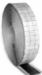
Spezielles Klebeband zum Ankleben der Folien und Vliese an bituminösen Untergrund, an Verwahrungen oder an Beton (Beton mit Haftgrund vorgestrichen); beidseitig klebend. Nur Montagehilfe, Verbindung nicht wurzelfest! Verarbeitungstemperatur ca. 20 °C.
