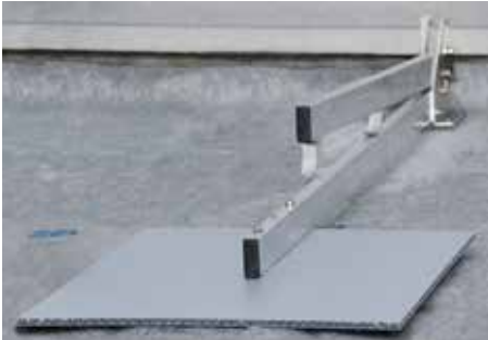
Das Pfostenmodul wird fertig vormontiert geliefert, lediglich der Pfosten selbst muss noch senkrecht oder in einem Winkel von 67,5 Grad montiert werden.
