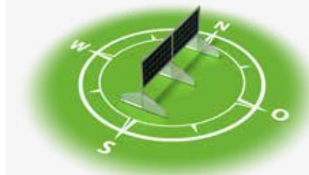
Senkrechte Anordnung bifacialer Module „Vertikal“
