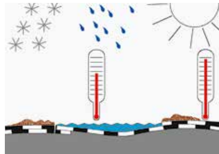
Risikobehaftete Pfützenbildung auf ungeschützter Abdichtung.
