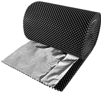
Druckstabile, rationell zu verlegende Drainagebahnen auf Basis der bewährten Floradrain®-Elemente, 25 oder 40 mm hoch, FD 25 auch mit Vlieskaschierung.
