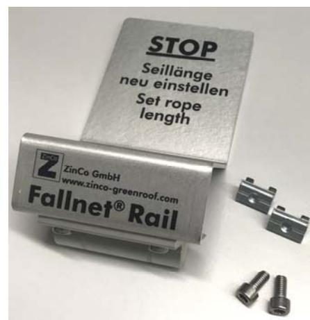
Das Federscharnier der Warntafel wird aufgeklappt und über die Schiene geführt. Dann wird die Warntafel mit den zwei Innensechskantschrauben M5 x 12 mm befestigt .
