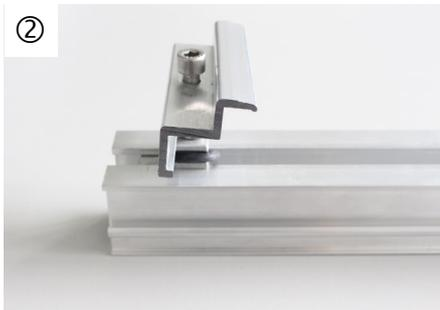
Das Photovoltaik-Modul wird unter die Klemmen geschoben und diese werden dann leicht angezogen. Auf der anderen Seite werden dann die Mittelklemmen in die Schiene eingehängt, siehe nächste Schritte.
