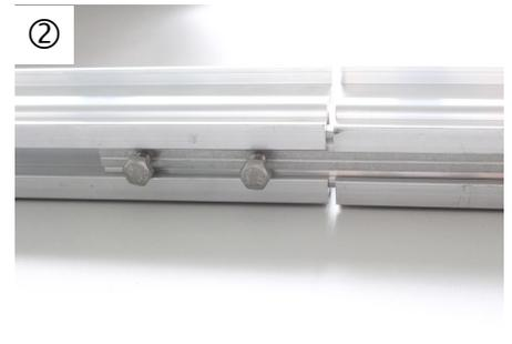
Die zweite Schiene auf den herausstehenden Verbinder schieben (Montagespalt siehe Tabelle). Der Längenausgleichsverbinder wird nur auf einer Seite verschraubt.
