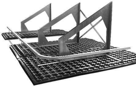
Durch Auflast gehaltene Anschlageinrichtung gemäß DIN EN 795, Typen D + E, mit horizontal beweglichem Anschlagpunkt für kurzzeitige Arbeiten mit einer Persönlichen Schutzausrüstung (z.B. ZinCo Fallnet® PSA-Set, Art.-Nr. 9024) auf Flachdächern bis max. 5° Dachneigung.
