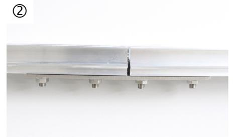
Die andere Schiene auf den herausstehenden Verbinder schieben. Alle Schrauben fest (12 Nm) anziehen.
