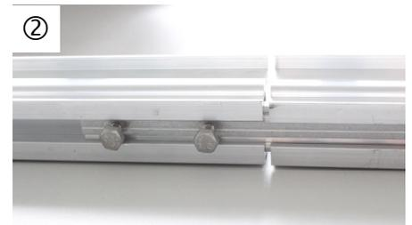
Die zweite Schiene auf den herausstehenden Verbinder schieben (Montagespalt siehe Tabelle). Der Längenausgleichsverbinder wird nur auf einer Seite verschraubt.
