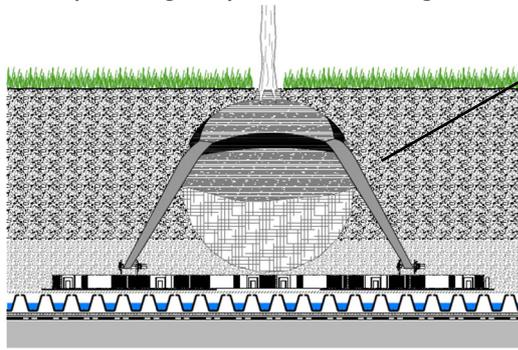
Baumverankerungssystem Robafix® mit Spann- und Fixierungsgurten, Rasterelementen und Ankergrundplatten
