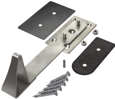
Stabiler Halter aus massivem Edelstahl zum Einbau in abgedichtete Schrägdächer nach dem Los- / Festflansch-Prinzip. Ersetzt in Verbindung mit den ZinCo-Traufprofilen Schubschwellen aus Holzwerkstoffen.
