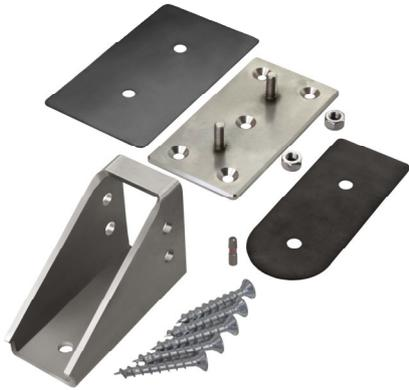
Hoch belastbarer Halter aus massivem Edelstahl zum Einbau in abgedichtete Schrägdächer nach dem Los- / Festflansch-Prinzip. Ersetzt in Verbindung mit den ZinCo-Traufprofilen Schubschwellen.
