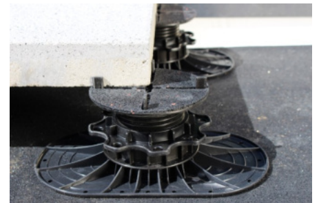
6 Als akustische Optimierung kann eine Dämpfungsscheibe verwendet werden, bei dünnen Platten (<35 mm) sollten die Dämpfungsscheiben immer verwendet werden
