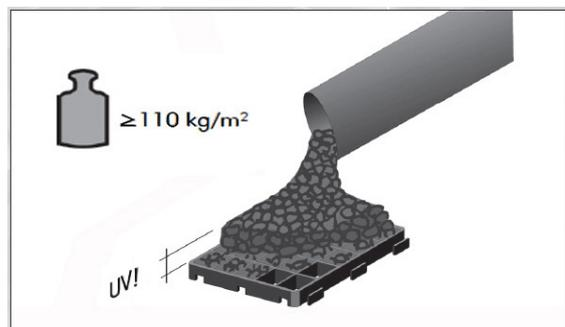
8. Aufbringen der erforderlichen Auflast (mind. 110 kg/m<sup>2</sup> im trockenen Zustand)
