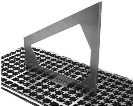
Für den Einsatz auf Gründächern konzipierte, aus einem Stück gefertigte und statisch geprüfte Grundrahmen aus Aluminium; abgestimmt auf die ZinCo Solarbasis® SB 200. Erhältlich in Neigungen zwischen 5° und 45°, abgestuft in 5°-Schritten.
